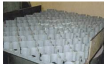
Prove di compressione eseguite su campioni dei pannelli Quadrifoglio . Compression tests executed on Quadrifoglio gratings' samples.
